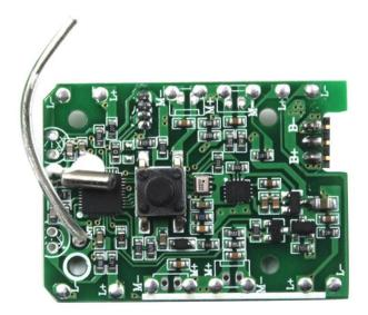
EVERY MOVEMENT OF A DRONE IS ACCOMPLISHED BY CHANGING THE SPIN RATE OF ONE OR MORE ROTORS. DOING THAT REQUIRES A CONTROLLER THAT CAN INCREASE OR DECREASE THE <u>VOLTAGE TO</u> <u>EACH MOTOR</u>.
